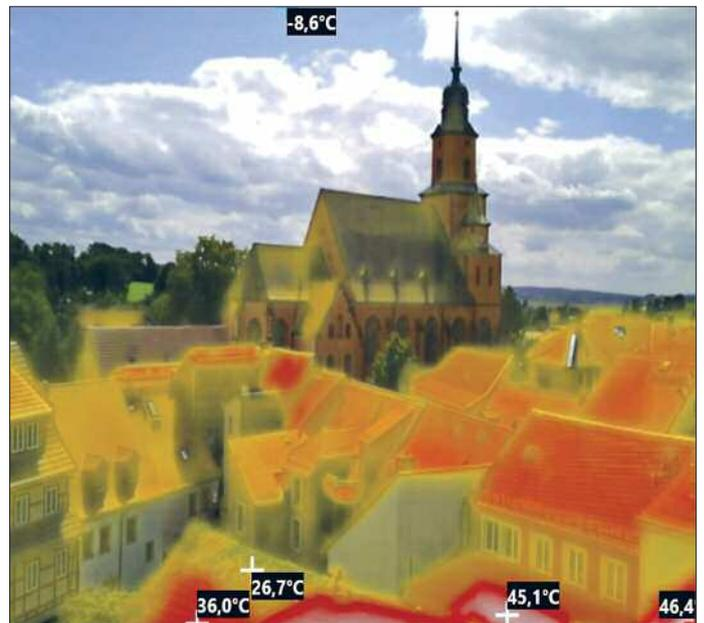
Wärmebildaufnahmen machen die heißesten Oberflächen sichtbar. In unteren Bereich dieser Aufnahme sieht man sehr schön den Unterschied zwischen einem Ziegeldach mit 36 Grad, das
