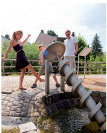
So sieht eine Archimedesschnecke aus. Schon gewusst?
